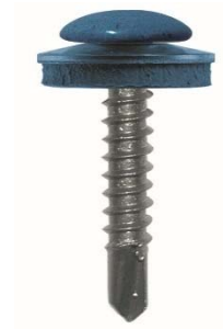
autoperceuse à tête bombée Ø 12 - Torx Panel Alu 3 TB12 Ø 4.8 x 25 mm + Rondelle VI 16
