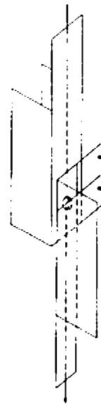
Figure 1.2 - Epruvette réalisée dans des profilés
